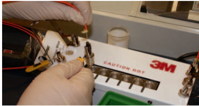
Im IT-Labor des Carl-Reuther-Berufskollegs wird ein Lichtwellenleiter von einem Schüler der Klasse IH81 (Höhere Berufsfachschule) im Hot-Melt-Ofen eingeklebt.
